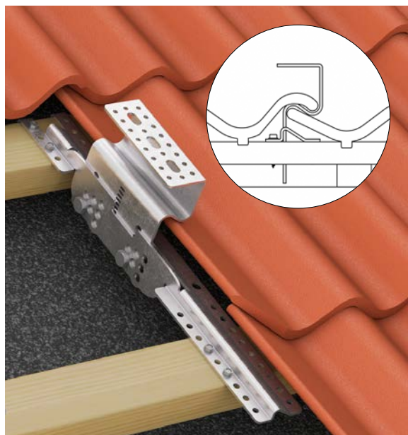
Läktfäste med fäste för ofalsad panna.
